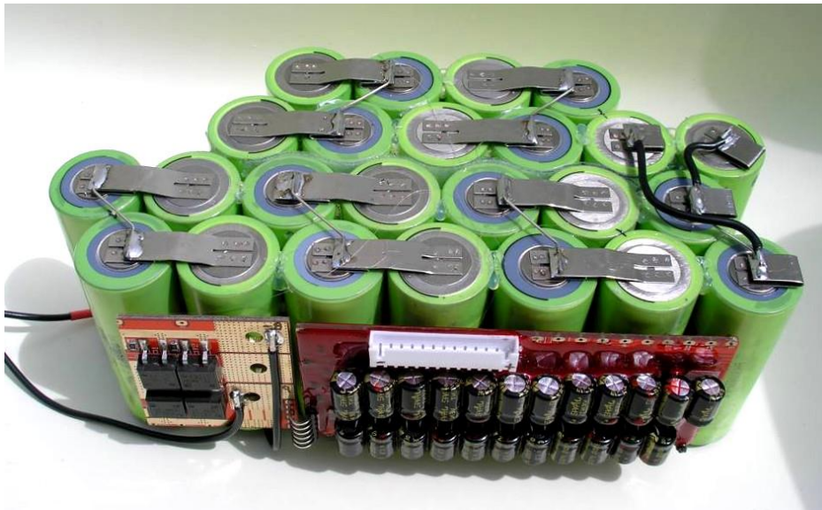
Exemple de module batterie avec interconnexions soudées et carte électronique
