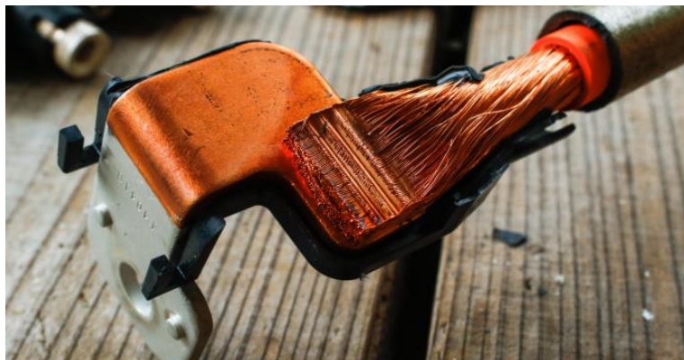
Figure 1 : Exemple de fil multibrin soudé sur un busbar
