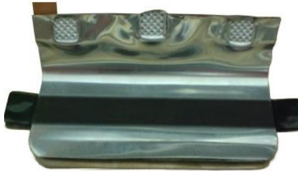
Figure 3 : Exemple de soudure tabs sur tabs
